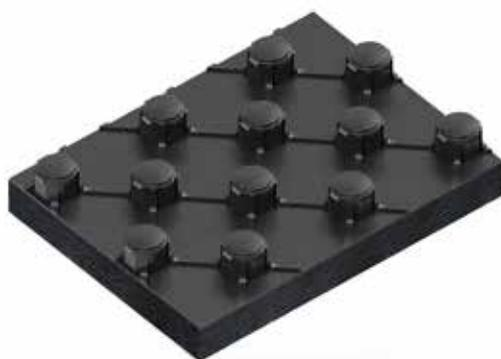
Pannello isolante bugnato **TOP GRAFITE** in polistirene espanso sinterizzato EPS a conducibilità termica migliorata, marchiato CE secondo la UNI 13163, accoppiato con un film termoformato in polistirene laminato HIPS (UNI EN 1264-4) di colore nero a protezione dell'isolante e delle bugne conformate e disposte in modo da consentire il perfetto alloggiamento del tubo multistrato o polietilene ( $16 < \varnothing < 18$ ), con passo di posa multiplo di 50 mm e possibilità di posa diagonale.
