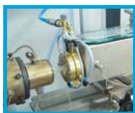
1° ESTRUSORE con controllo gravitermico (formazione tubo interno)
